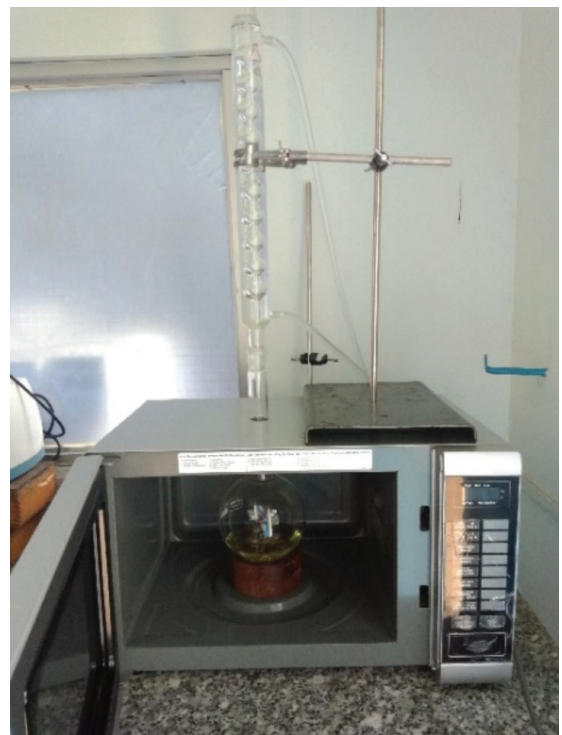
Hình 2: Hệ thống trích ly caffeine bằng dung môi có hỗ trợ vi sóng.
