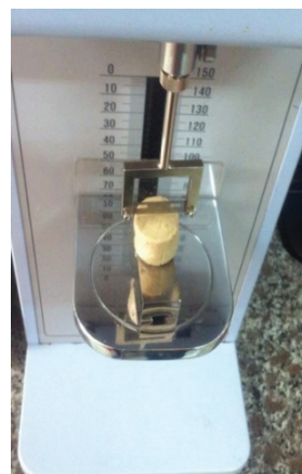
Hình 2. Đầu đo lực nén vỡ (trái) và lực cắt (phải)
