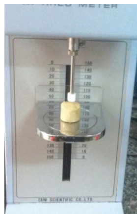
Hình 2. Đầu đo lực nén vỡ (trái) và lực cắt (phải)
