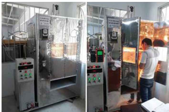
Hình 3.3. Hình ảnh máy sấy bằng HP-IR đã được chế tạo.
