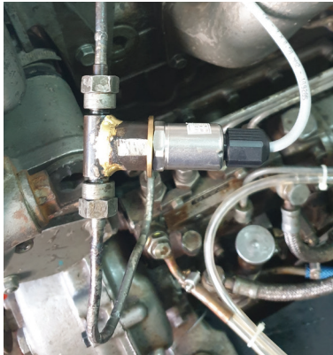
Hình 11. Cảm biến áp suất lắp trên đường ống cao áp
