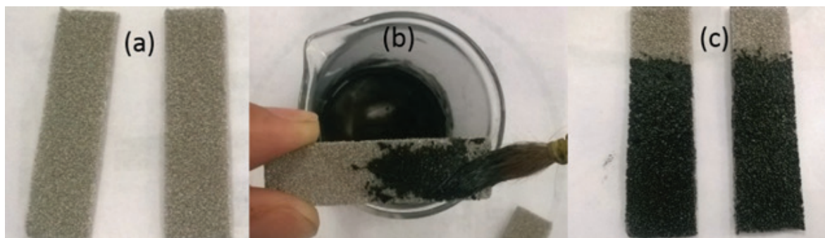
Hình 1. Tấm Ni foam (a) trước, (b) trong, (c) sau khi phủ lớp vật liệu graphene/NiCo 2 O 4
