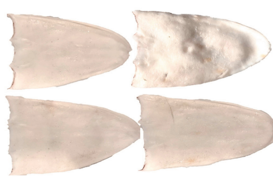
Hình 3.8. Kết quả sấy thực nghiệm mực lột da bằng thiết bị sấy CKVS.
