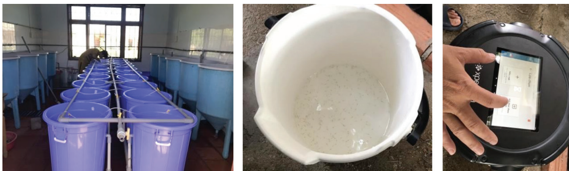
Hình 1. Hệ thống bể thí nghiệm và máy đo số lượng, chiều dài, khối lượng tôm.
