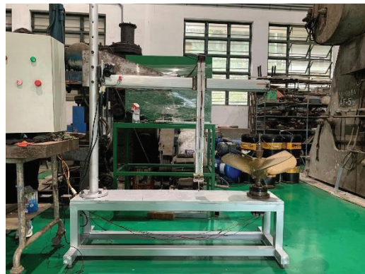
Hình 5. Thiết bị đo kích thước hình học chân vịt.
