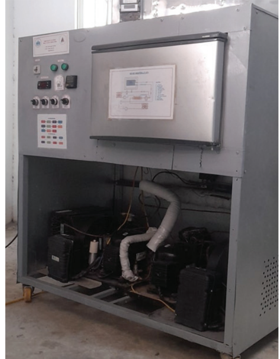
Hình 5. Hình ảnh tủ cấp đông phục vụ sấy thăng hoa hoàn thiện.
