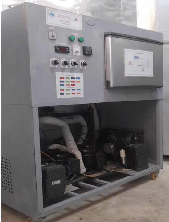
Hình 5. Hình ảnh tủ cấp đông phục vụ sấy thăng hoa hoàn thiện.
