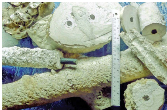
Hình 4: Vật liệu phát triển trên thanh sắt sau hai năm sử dụng công nghệ Biorock [22]
