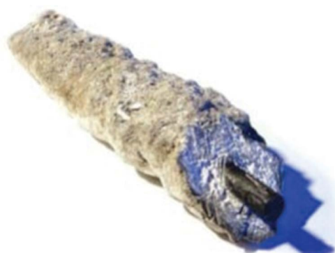
Hình 4: Vật liệu phát triển trên thanh sắt sau hai năm sử dụng công nghệ Biorock [22]
