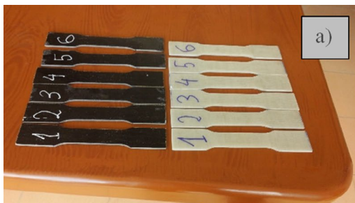
Hình 3. Mẫu thử uốn và thử kéo
