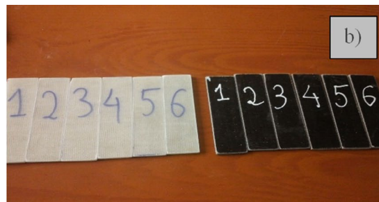
Hình 3. Mẫu thử uốn và thử kéo
