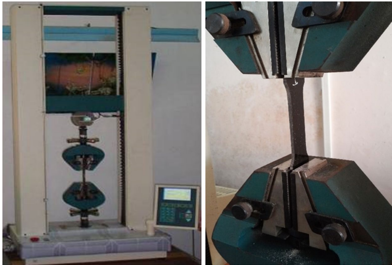
Hình 4. Máy kiểm nghiệm cơ tính vạn năng HOUNSFIELD Model H50KS
