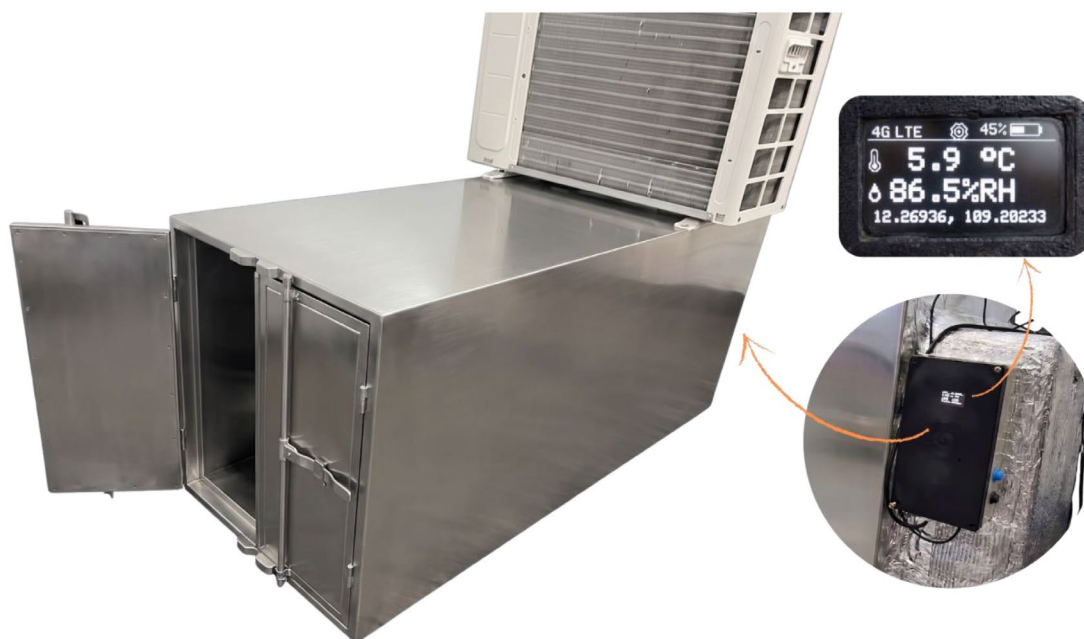
Hình 5. Mô hình container lạnh thực tế (trái) và cận cảnh cụm thiết bị IoT (phải)
